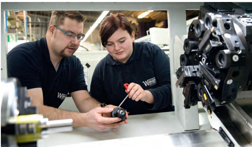
Nisa und Ausbildungsleiter Holger Hillenbrand beim Einrichten einer CNC-Drehmaschine.
